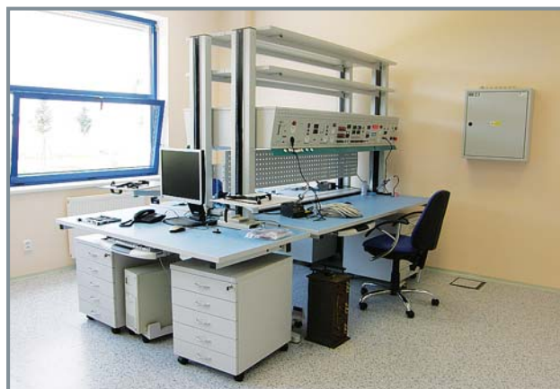
Pracovní ostrov v antistatickém provedení s boční pracovní deskou bez nohou se zavěšenými elektronástavbami, policemi a deskou na nářadí, ZAT Plzeň
