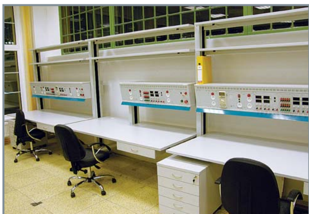
Řetězená sestava se zavěšenými elektronástavbami s místem pro monitor a policemi, Škoda electric Plzeň
